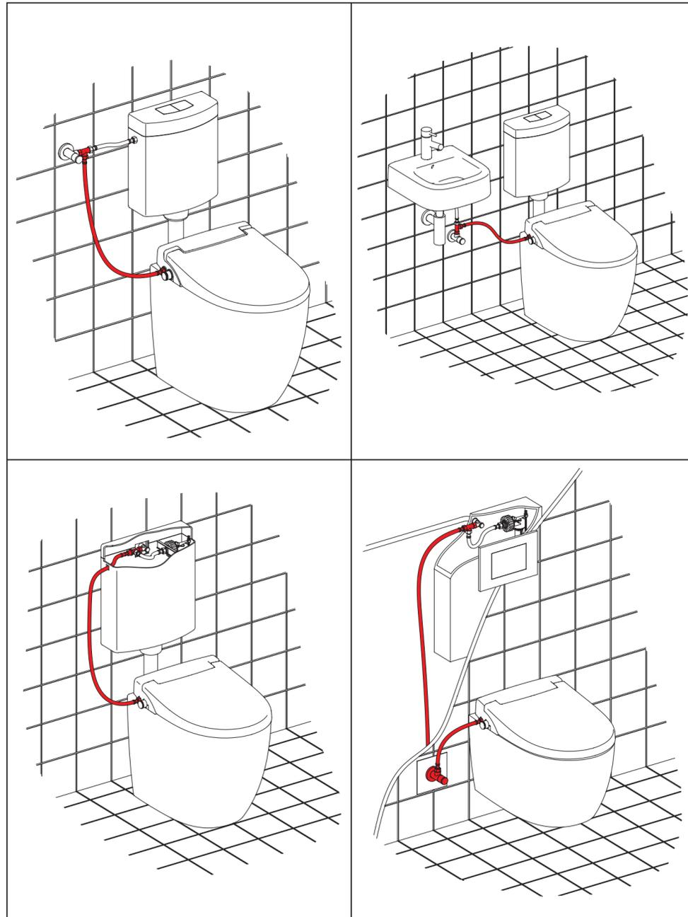
T-Stück, IG x AG x AG 3/8", zur Wasserentnahme am Eckventil im Lieferumfang enthalten. Ohne Anschlusschläuche.
